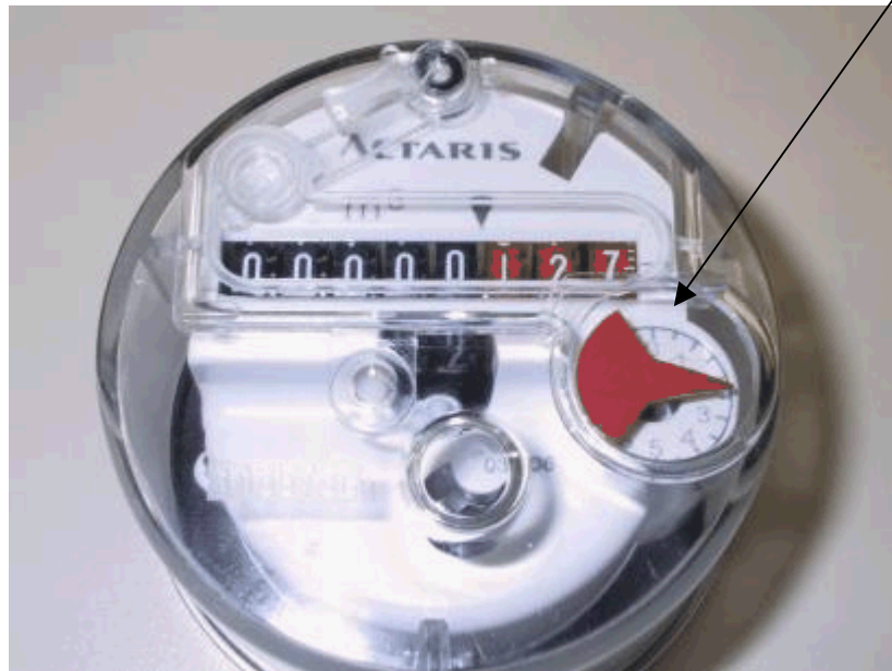
Totalisateur équipé de la nouvelle aiguille « cible »
