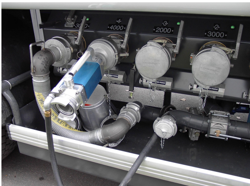
Ensemble de mesurage ALMA type FLEXICOMPT positionné sur l'adaptateur API du camion-citerne
