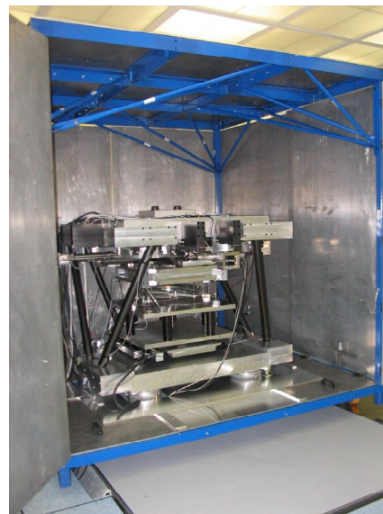
fig. 2 – Machine dans le caisson thermique passif
