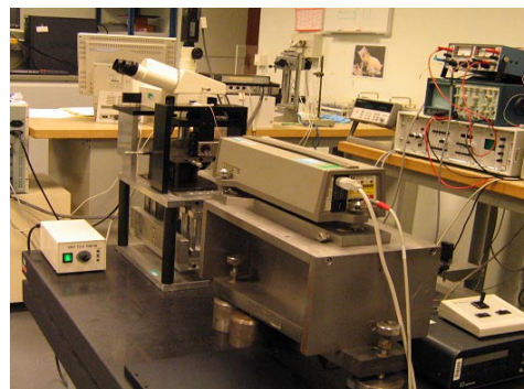
Photo 1 : Vue du banc de mesure des micromètres objets
