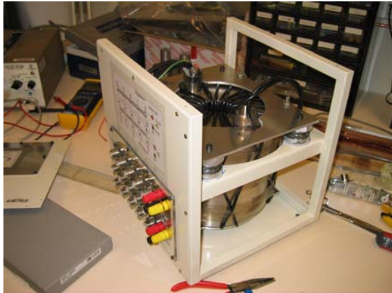
Figure 8 : transformateur de tare dédié à l'étalonnage des transformateurs étalons
