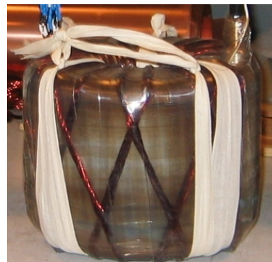
Figure 2: vue de l'enroulement métrologique bobiné selon la méthode "Ayrton-Perry"
